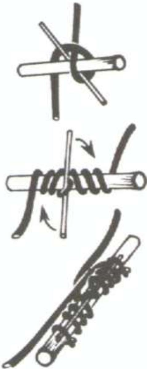
E' bene ricorrere a questo strumento quando non se ne hanno altri a disposizione perché l'attorcigliamento attorno al palo "stressa" notevolmente le corde soprattutto quelle di canapa.
